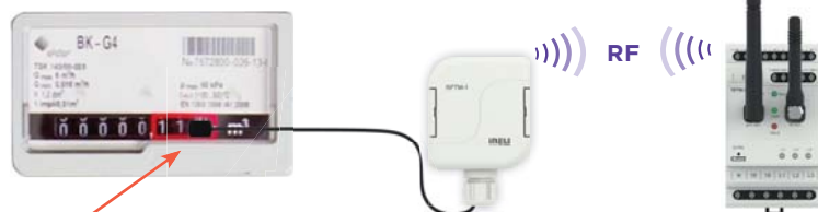
Położenie czujnika na gazomierzu
