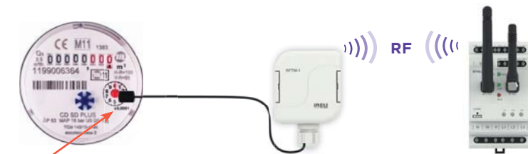
Rotujący wskaźnik licznika zużycia wody
